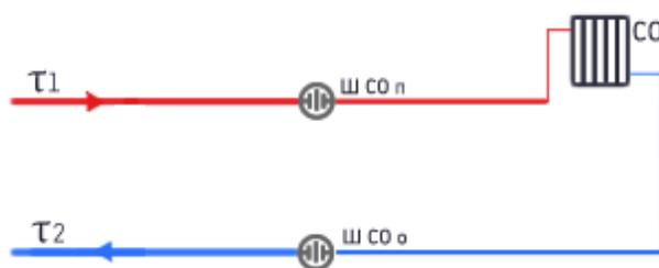
Рис. 5 Схема подключения потребителей с непосредственным присоединением системы отопления.
